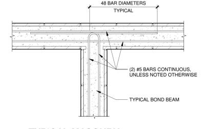
**4 TYPICAL MASONRY BOND BEAM INTERSECTION**
