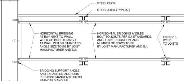
**2 HORIZONTAL JOIST BRIDGING AT WALL**
