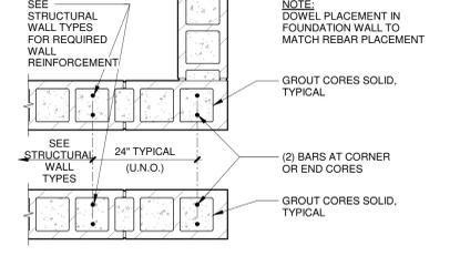
**3 TYPICAL MASONRY BOND BEAM**
