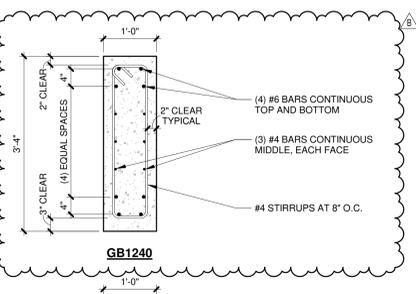
**7 TYPICAL NEW TO EXISTING GRADE BEAM CONNECTION**
