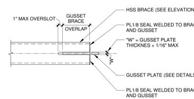
**13 BRACED FRAME SLOT CUT**
