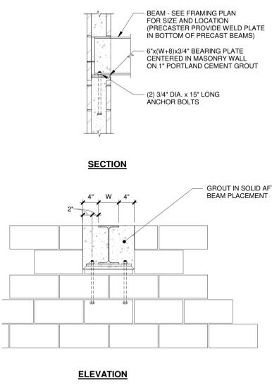
**10 STEEL BEAM BEARING ON MASONRY**
