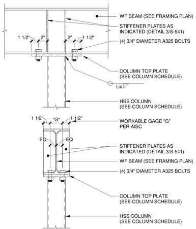
**20 TYPICAL WF BEAM OVER HSS COLUMN**
