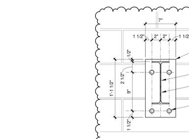
**23 PLATFORM WF BEAM CONNECTION AT MASONRY**
