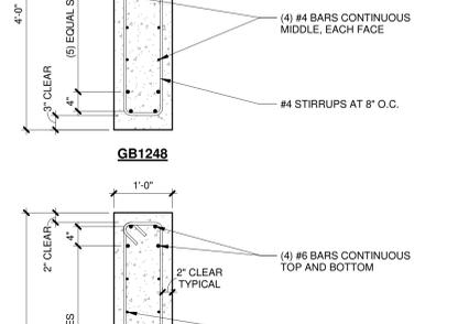
**8 TYPICAL MASONRY WALL AT GRADE BEAM**
