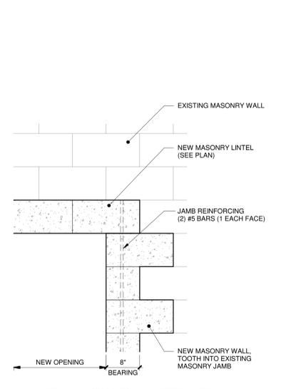
**13 NEW MASONRY LINTEL AT EXISTING MASONRY WALL**
