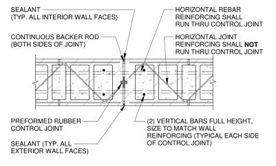
**5 TYPICAL MASONRY CONTROL JOINT**
