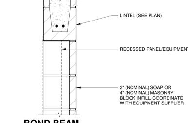
**16 BOND BEAM LINTEL AT RECESSED PANEL/EQUIP**
