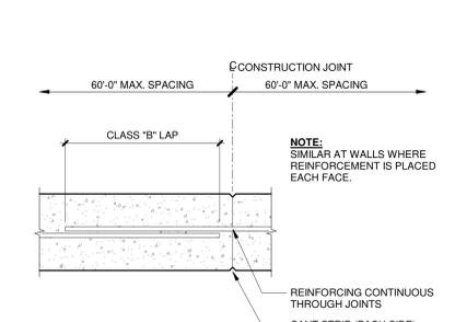
**9 TYPICAL FOUNDATION AND CONCRETE WALL CONST. JOINT**
