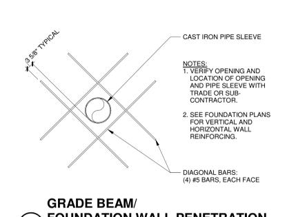
**12 GRADE BEAM/FOUNDATION WALL PENETRATION**
