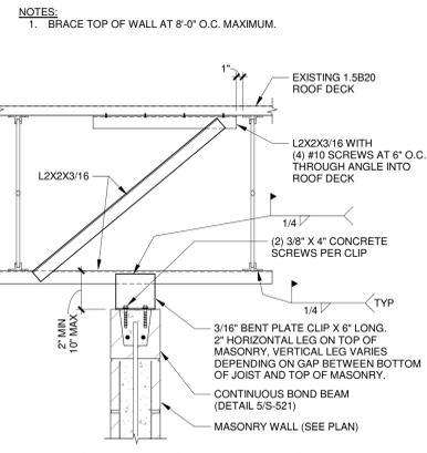
**17 TYPICAL TOP OF WALL BRACING WALL PARALLEL TO JOIST**
