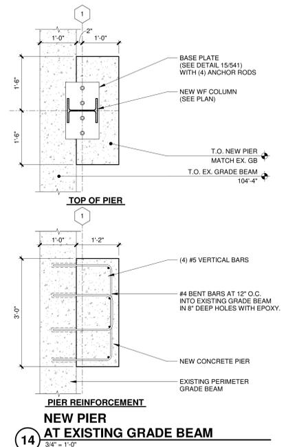
**14 PIER REINFORCEMENT NEW PIER AT EXISTING GRADE BEAM**
