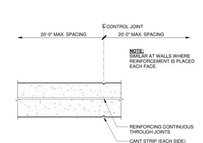
**10 TYPICAL FOUNDATION AND CONCRETE WALL CONTROL JOINT**
