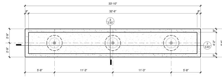
**6 ENLARGED FOUNDATION PLAN - ECO 60-13 LIFT**
