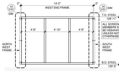
**13 MAU4 SCREEN WALL FRAMING ELEVATION (LOOKING EAST)**
