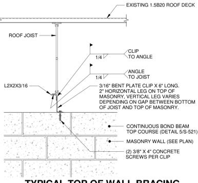
**18 TYPICAL TOP OF WALL BRACING WALL PERPENDICULAR TO JOIST**
