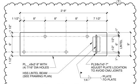
**20 HSS LINTEL BEAM CONNECTION TO MASONRY**
