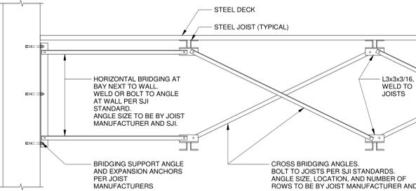
**3 DIAGONAL JOIST BRIDGING AT WALL**
