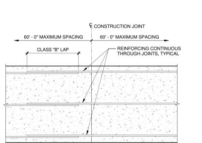
**4 TYPICAL GRADE BEAM CONSTRUCTION JOINT**
