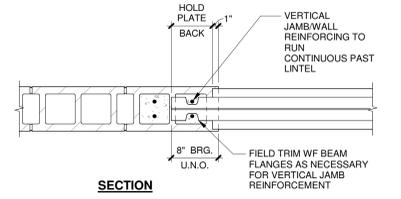
**12 WF BEAM LINTEL BEARING**
